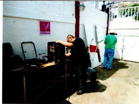
Reparación de la máquina eléctrica de soldadura (cambio de bornes de terminales).
