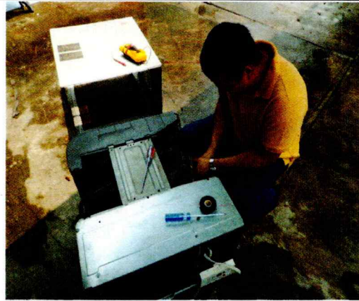
Reparación de un aire acondicionado tipo ventana (cambio de terminales del motor compresor).
